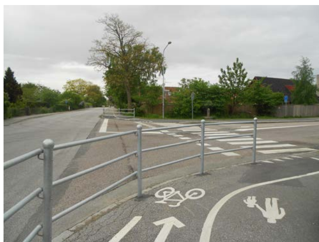
Figur 10-17. Indragen passage från korsning med låg framkomlighet för cykeltrafiken.
