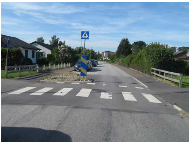
Figur 9-10. Avsmalning av Ringvägen för det viktiga cykelstråket mellan Vinstorp och Pilängsskolan.
